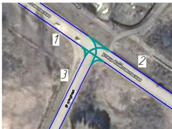
Рисунок 11 – Схема расположения модельных детекторов времени проезда
