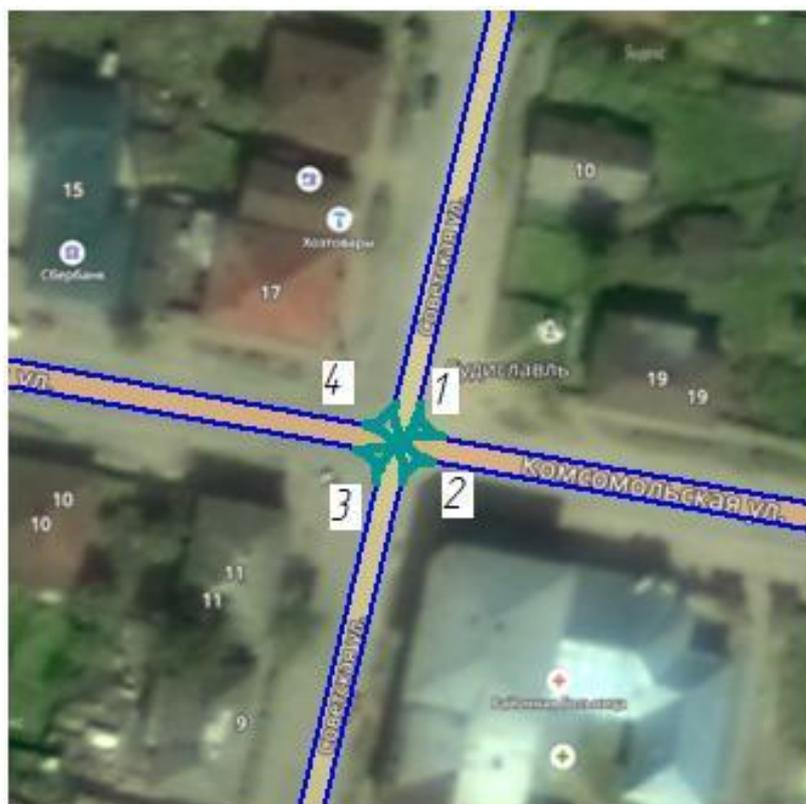
Рисунок 4 – Схема расположения модельных детекторов времени проезда
